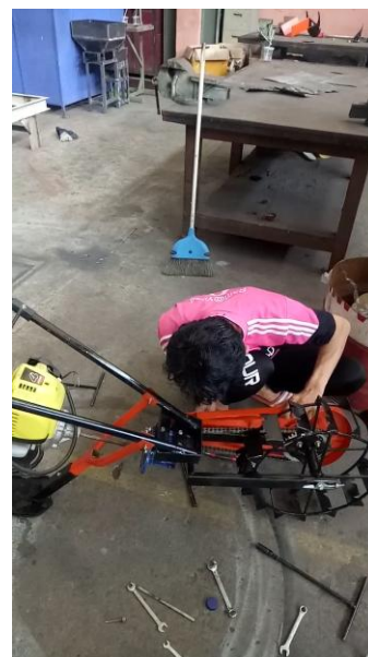
Gambar 7. Proses Pemasangan Motor Penggerak
