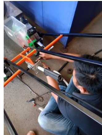
Gambar 11. Proses Pemasangan Transmisi 1.7. Proses Finishing
