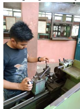
Gambar 8. Proses Pembubutan Gear Nozzel
