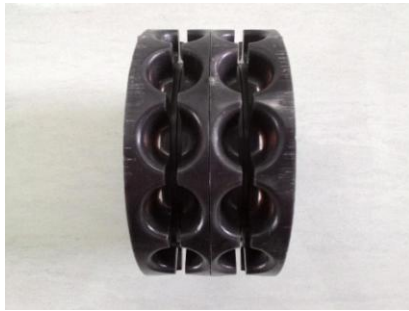
Gambar 9. Gear Nozzel Pengatur Biji Jagung 1.5. Proses Pemasangan Motor Penggerak
