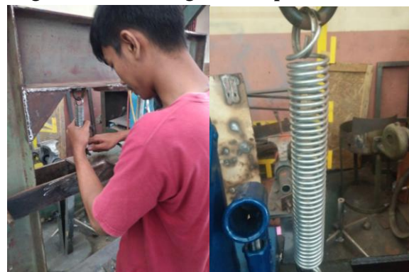
Gambar 10. Proses Pemasangan Pegas
