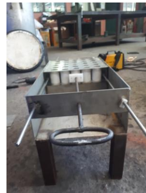
Gambar 7. Pemasangan media cetak pada alat cetak
